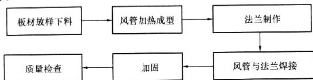
图 5.5.1 硬聚氯乙烯风管与配件制作工序
