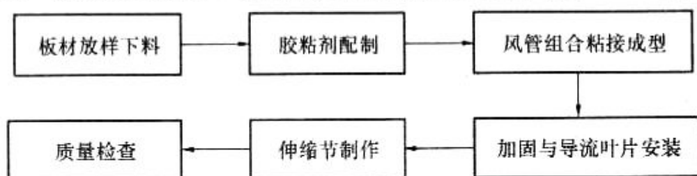
图 5.4.1 玻镁复合风管与配件制作
