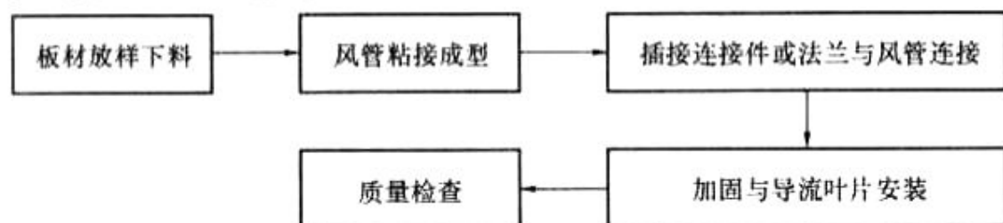
图 5.2.1 聚氨酯铝箔与酚醛铝箔复合风管及配件制作工序
