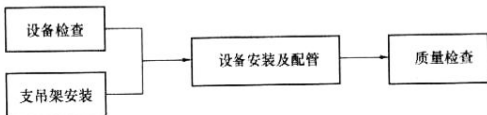
图 9.2.2 空调末端装置安装工序
