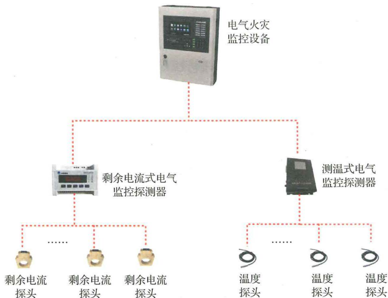
图 12-7 电气火灾监控系统构成示意图
